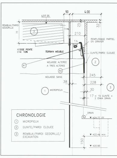
Fig. 2. – Stabilisation du terrain par micropieux et par géogrille: coupe type
