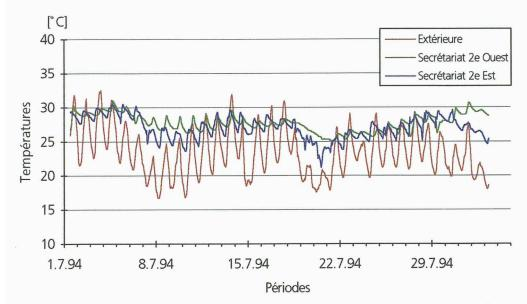
Fig. 1. – Températures extérieures et intérieures mesurées pour des locaux situés au 2º étage de l'EPSIC, mois de juillet 1994
