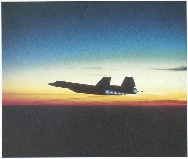
L'avion le plus rapide du monde (homologation officielle: 3529,56 km/h, le 28 juillet 1976). Les spécialistes en mécanique des fluides apprécieront les ondes de choc visibles derrière la tuyère des réacteurs. (Photo Lockheed)
