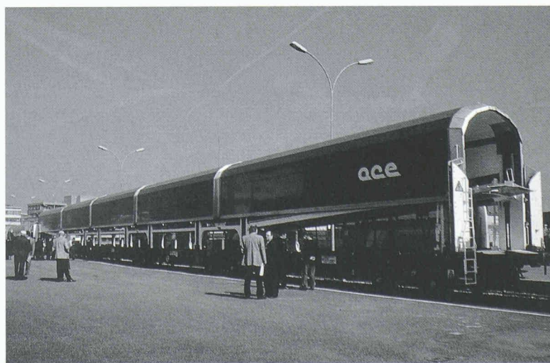
Vu à l'exposition de la CIA: wagons porte-autos à deux niveaux articulés à cinq éléments, entièrement fermés QCE (la partie supérieure s'abaisse une fois les voitures chargées). Un convoi peut comporter jusqu'à onze wagons et rouler à 120 km/h.
