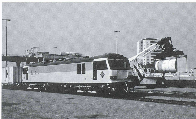
La Grande-Bretagne au bout des rails: ici l'une des 46 nouvelles locomotives électriques bicourant (750 V continu en Angleterre, 25 kV/50 Hz dans le tunnel) de la classe 92, acquises pour le trafic Transmanche (dont 7 pour les trains voyageurs de nuit). L'équipement électrique est fourni par ABB, la partie mécanique par Brush Traction Ltd, Loughborough, et Prorail, Wakefield.
