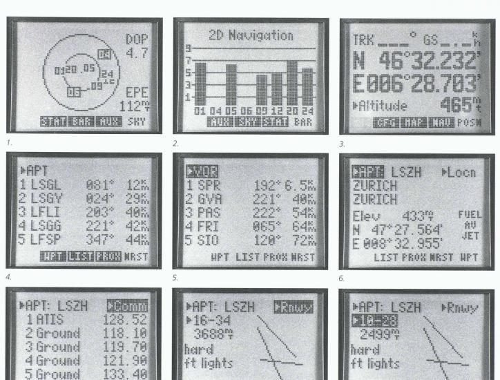
Fig. 6 — Quelques-unes des nombreuses possibilités offertes par le Garmin AV 95 ou par d'autres récepteurs disponibles sur le marché aéronautique. Chacune des fonctions est facilement accessible en vol comme au sol, grâce au clavier alphanumérique.
