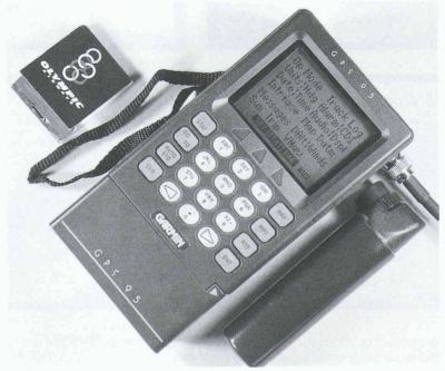
Fig. 5. – Un récepteur GPS portable destiné à l'aviation: le Garmin AV 95; la pochette d'allumettes permet de juger de ses dimensions modestes. L'antenne, cylindre noir posé le long de l'instrument, est soit directement fixée sur celui-ci, soit montée sur un emplacement favorable à la réception (p. ex. sur le haut du pare-brise de l'avion).
