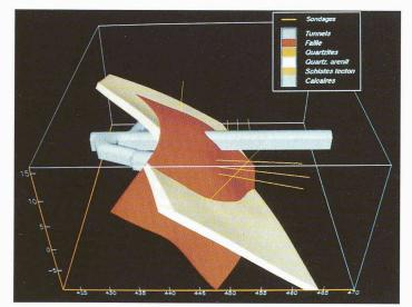
Fig. 8. – Tunnel fictif en contexte alpin Coupe oblique le long du tunnel. Le pendage des couches par rapport à la pente du tunnel est nettement observable.
