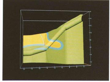
Fig. 10. – Tunnel fictif en contexte alpin Le curseur tridimensionnel indique les coordonnées exactes de l'intersection des deux failles et du tunnel.
