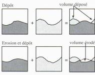
Fig. 5. – Vue en coupe des principaux types de relations géométriques entre formations géologiques, traduites dans le modèle par des règles d'intersection des surfaces. Le dépôt est traduit par une surface recouvrante, l'érosion-dépôt par une surface sécante et recouvrante.
