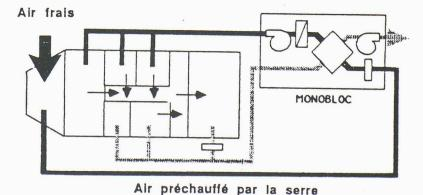
Fig. 1.- Renouvellement d'air contrôlé dans un bâtiment équipé d'une serre [4]
