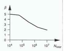
Fig. 5. – Relation schématique entre indice de fiabilité β et nombre de cycles de charge N<sub>futur</sub> pouvant encore être appliqués
