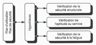
Fig. 1. – Démarche générale d'évaluation d'une structure existante
