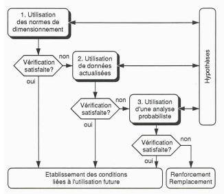
Fig. 2. – Principe d'évaluation par étapes, valable pour les vérifications de la sécurité structurale, de l'aptitude au service et de la sécurité à la fatique
