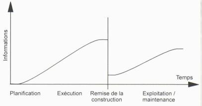
Fig. 1. – Perte d'informations à l'achèvement d'une construction
