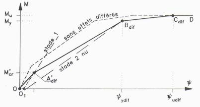
Fig. 2. – Lois moment-courbure avec effets différés
