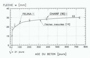
Fig. 6. – Comparaison des flèches mesurées et calculées (d'après les données recommandées dans [16])
