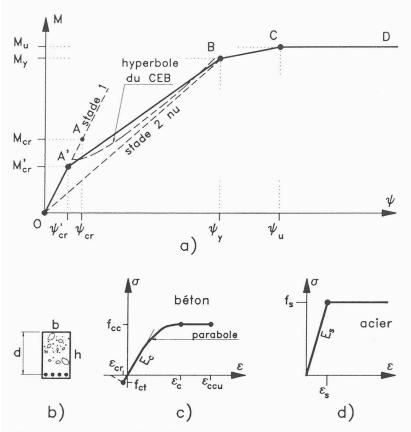
Fig. 1.- Lois moment-courbure d'une section en béton armé
