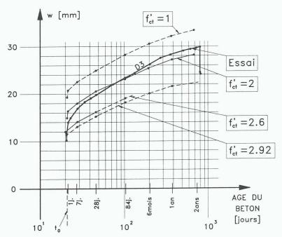
Fig. 5. – Flèches mesurées (essai) et calculées (pour diverses valeurs de f'ct)
