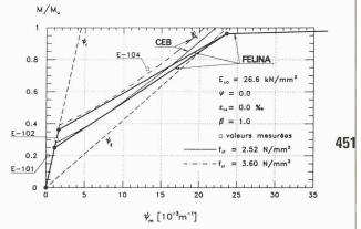
Fig. 9. – Béton A1, sans effets différés (essai à 28 jours)
