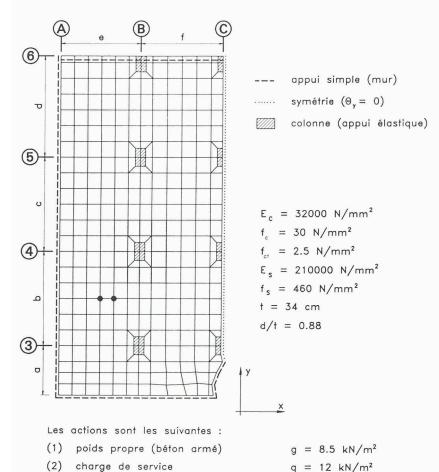
charge de service "longue durée" Fig. 7. – Zone ouest de la dalle de parking analysée dans [5]
