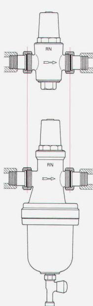
Les réducteurs de pression actuels (construction courte) peuvent être remplacés par un REDFIL sans modification aucune de l'installation existante.
