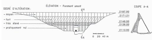
Fig. 2. – Etat du parement amont avant les travaux
