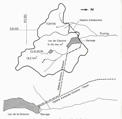
Fig. 1. – Barrage de Cleuson: situation d'ensemble de l'aménagement
