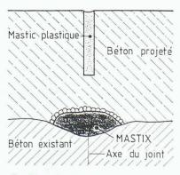
Fig. 11. – Coupe en travers d'un joint vertical
