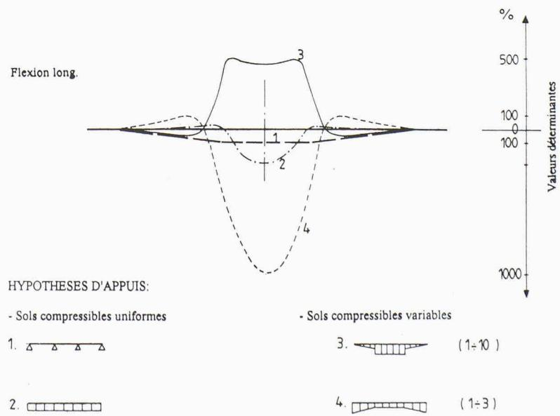
Exemple 1 - Influence des hypothèses d'appuis sur les efforts longitudinaux déterminants de la structure pour un sol de compressibilité uniforme ou variable (admise d'après l'étude géotechnique): cas d'une auge enterrée d'environ 100 m avec segment central en caisson
