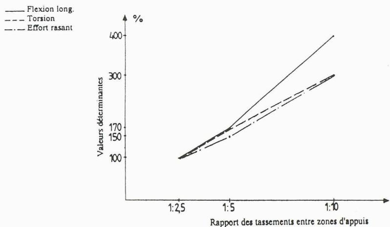
*Exemple 2 - Influence sur une structure de caisson enterré d'environ 100 m des hypothèses de tassement différentiel par zones d'appui dans le cas d'un terrain hétérogène, donc sujet à très forte variation de compressibilité*
