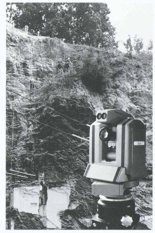
Pendant que la réfection de la paroi rocheuse s'effectue dans des conditions dangereuses, le théodolite motorisé Wild TM3000 du système Leica APSWin, installé à bonne distance, réalise en mode automatique des mesures de haute précision sur des points situés à gauche et à droite de la zone de glissement. Jusqu'ici, aucun autre mouvement n'a été enregistré sur le versant critique.
