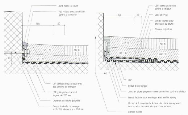
Fig. 2. – Raccord 2: raccord avec bande de serrage sur béton
