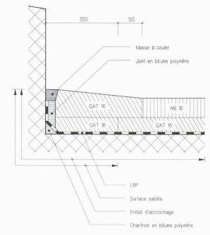
Fig. 6. – Raccord 8: raccord collé à base de bitume, remontée de LBP
