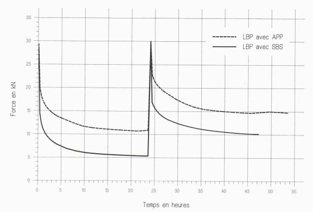
Fig. 10. – Raccord 4: réduction de la force de serrage
