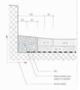
Fig. 8. – Raccord 9: raccord collé à base de bitume, joint de bord coulé
