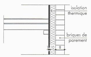
Fig. 7 – Coupe verticale d'un mur avec isolation extérieure et briques de parement
