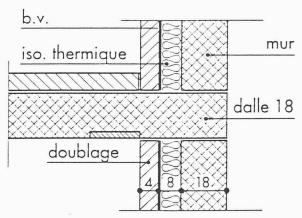
Fig. 1. – Coupe verticale d'une isolation intérieure
