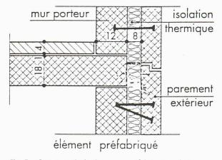
Fig. 5 – Coupe verticale d'un mur préfabriqué en béton
