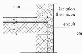
Fig. 2. – Coupe verticale d'une isolation extérieure
