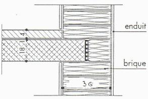
Fig. 8 – Coupe verticale d'un mur avec isolation répartie sur l'épaisseur
