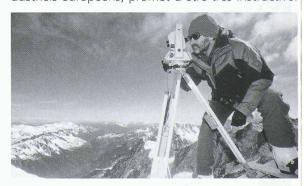
Les lieux de prélèvement de glace ont été déterminés à l'aide de mesures radar et de relevés réalisés avec l'instrument électronique de mesure laser Wild TC1610. Ces données recueillies à une altitude de 4300 m permettent au savant Louis Reynaud (photo) de calculer les variations de volume et les vitesses de déplacement de la glace.
