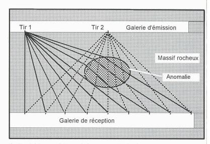
Fig. 7. – Schéma synthétique de la tomographie sismique
