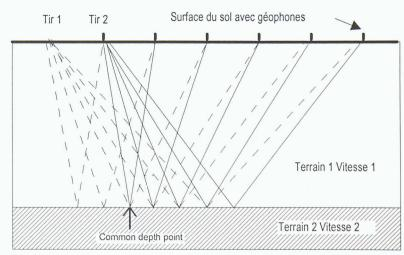
Fig. 5. - Schéma de la sismique réflexion selon la méthode de la couverture multiple (Common depth point)
