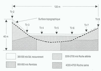
Fig. 4. – Exemple de profil sismique réfraction au travers d'une décharge
