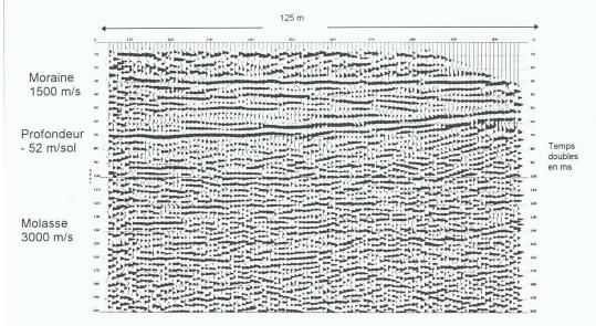
Fig. 6. – Exemple de profil sismigue réflexion
