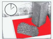
Ces trois photos démontrent la circulation de l'eau au travers d'une couche normale de TALTEX et la montée de l'humidité par capillarité dans un bloc de mastic TALTEX.
