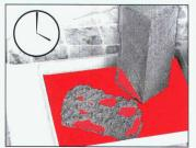
En une heure de temps, la couche de TALTEX commence à être traversée. Dans le mastic TALTEX l'eau gravite 2 à 3 fois plus vite que dans le TALTEX normal.
