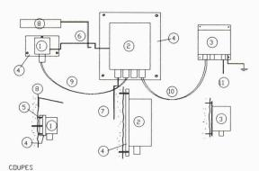
Fig. 13. – Configuration type d'une station d'accélérographe:
