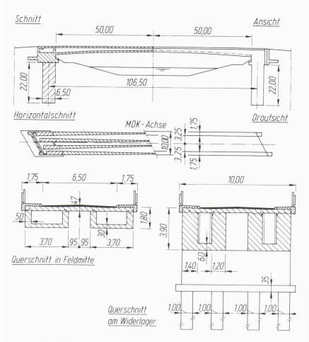
Pont Sud près de Berching, projet réalisé: pont-cadre aux montants constitués de parois moulées
