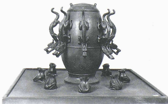
Sismographe inventé en l'an 132 par le savant Zhang Heng. A l'intérieur de l'urne, un pendule réagit aux secousses et déclenche un mécanisme qui fait lâcher à l'un ou l'autre des dragons une bille en bronze destinée à tomber dans la gueule d'une grenouille.
