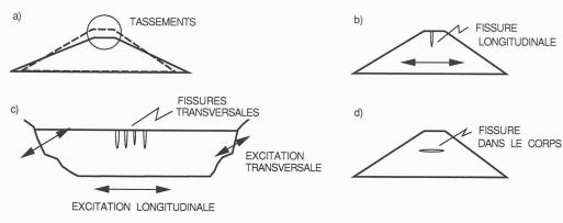
Fig. 5. – Déformations permanentes et fissures dans les diques
