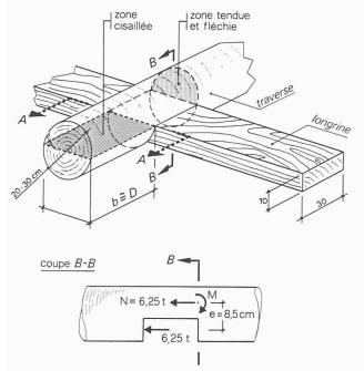
Fig. 8.- Assemblage longrine-traverse
