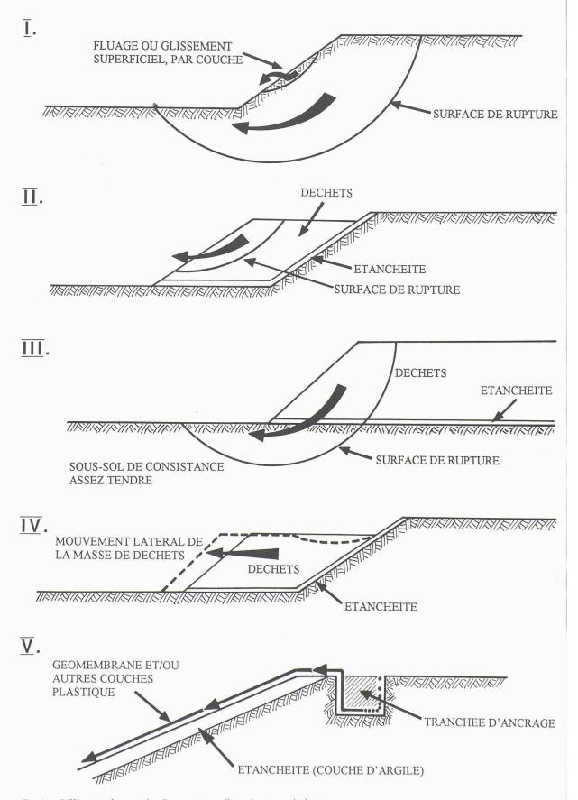
Fig. 1. – Différentes formes de glissement possibles dans une décharge
