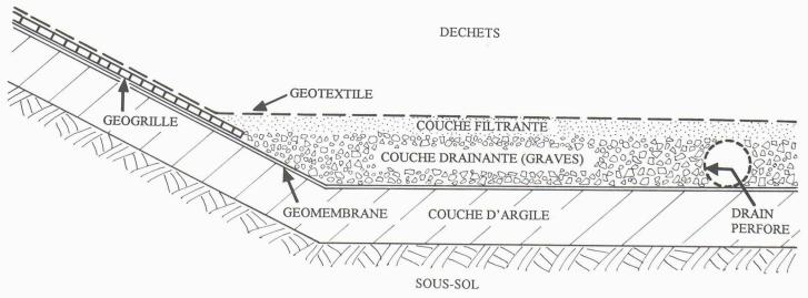
Fig. 2. – Exemple de drainage d'une décharge
