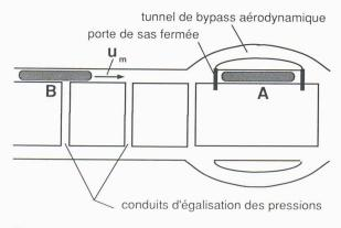
Fig. 4. – Scénario montrant un train (A) à l'arrêt, et un train (B) à pleine vitesse  $(u_m)$ , s'approchant de A
