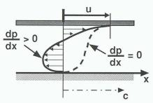
Fig. 8. – Ecoulement du type Couette turbulent entre deux plaques planes
