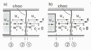
Fig. 9. – Esquisse du choc normal généré par l'accélération instantanée du métro. a) Cas avec  $\dot{M}_{a}^{(m)}=0$  (c<sub>2</sub>=u<sub>m</sub>); b) cas avec  $\dot{M}_{a}^{(m)}\neq 0$  (c<sub>2</sub><u<sub>m</sub>)
