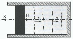
Fig. 2. – Jeu d'ondes dans un cylindre court. u = vitesse du piston
