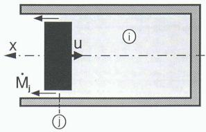
Fig. 3. – Débit  $\dot{M}_j$  limité par le blocage sonique  $(Ma_i=1)$
