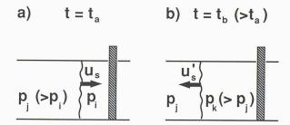
Fig. 6. – Augmentation de pression au passage d'une onde réfléchie sur une paroi a) avant, b) après la réflexion
