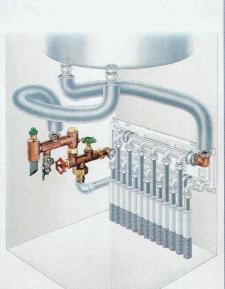
Type HWU convient pour chauffe-eau encastré avec élément chauffant inférieur
