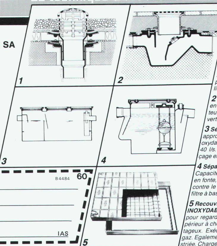
**1 Garniture d'écoulement en fonte pour toiture, PASSAVANT,** sorties verticale et latérale en une ou deux parties, réglable en hauteur avec anneaux de surélevation, grille sphérique, ou plate, ronde ou carrée, praticable, ou résistant au trafic lourd. Pourvue, non seulement d'une surface de collage, mais avec en plus, d'une bride de fixation assurant une liaison très résistante. Approuvé **ASPEE**.
