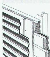
**La souplesse:** les nouvelles cassettes MONTAWALL® mesurent de 330 à 600 mm de haut et de 60 à 150 mm de large. Sur demande, Montana livre également des cassettes de raccord variables de 300-625 mm en hauteur et jusqu'à 16 m en longueur.
