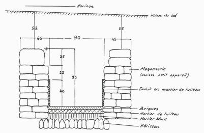
Fig. 3.- Aqueduc de Nyon: coupe dans le secteur de Borex (F. Mognetti, F. Ledgard: «Etude du point de vue de l'ingénieur de l'aqueduc Divonne-Nyon», EPFL, 1989, A. 19)
