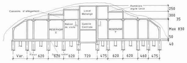
Fig. 5. – Réservoirs de Bernex: coupe transversale des cuves E et F
