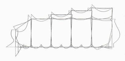
Fig. 7. – Examen de la structure dans son ensemble: diagramme des moments de flexion
