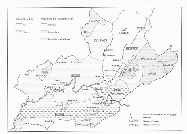
Fig. 3. – Réseaux de distribution d'eau à Genève
