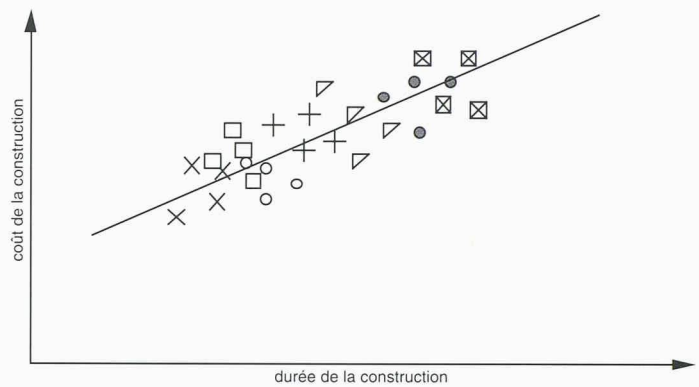
Fig. 8. — Exemple de résultats de simulations de la construction d'un tunnel. Les points de même symbole correspondent à des constructions à travers le même profil géologique. Une disposition telle que celle-ci permet de conclure que l'incertitude de la géologie prime sur celle des données constructives.
