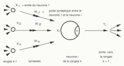
Fig. 4 – Schéma du fonctionnement d'un neurone artificiel L'entrée  $E_i$  est la somme des contributions de tous les neurones convergeant vers le neurone i, c'est-à-dire:
