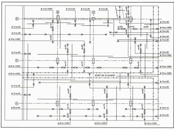
Fig. 3b. – Détail des plans d'armatures supérieures
