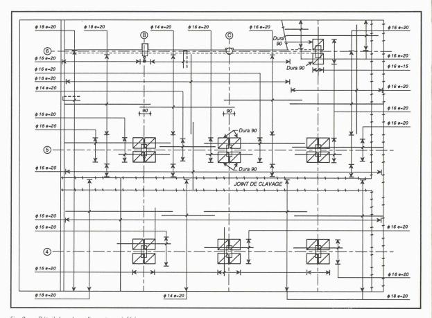
Fig. 3a. – Détail des plans d'armatures inférieures
