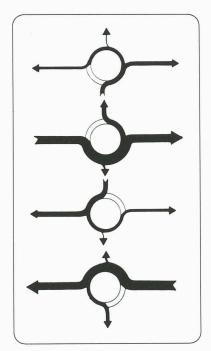
Fig. 11. - Répartition des flux de circulation par branches d'entrée et itinéraires de sortie.
