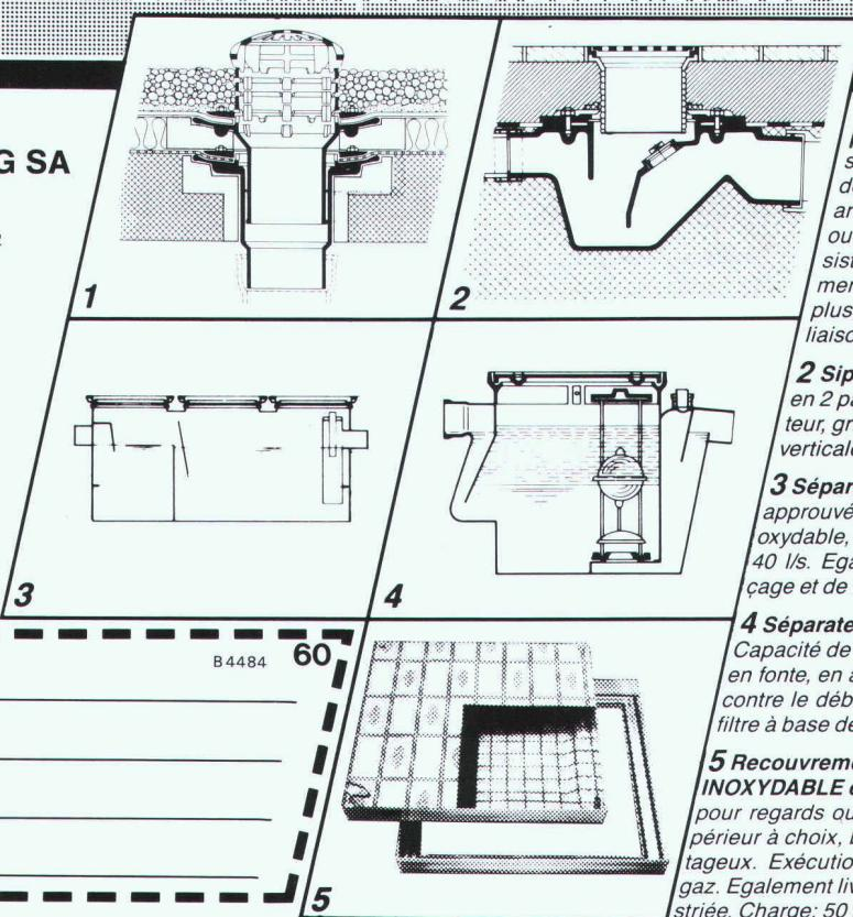
**1 Garniture d'écoulement en fonte pour toiture, PASSAVANT,**
