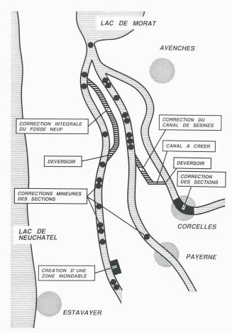
Fig. 5. – Schéma d'aménagement général des eaux (SAGE) de la Broye: aménagements à réaliser
