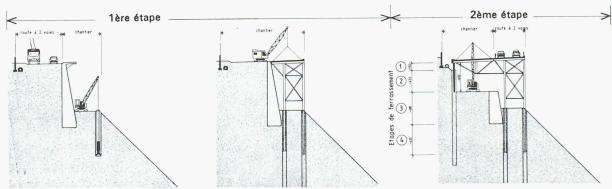
Fig. 4. – Le chantier est parallèle aux circulations, construction en aval.
