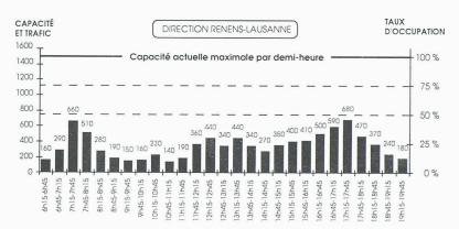
Fig. 9. — Volume de trafic par demi-heure sur le tronçon le plus chargé de la ligne TSOL — jour de semaine en hiver 1991 (extrait de 6 h 15 à 19 h 45) et comparaison avec la capacité directionnelle. En places assises, la capacité directionnelle est de 550 voyageurs par demi-heure.
