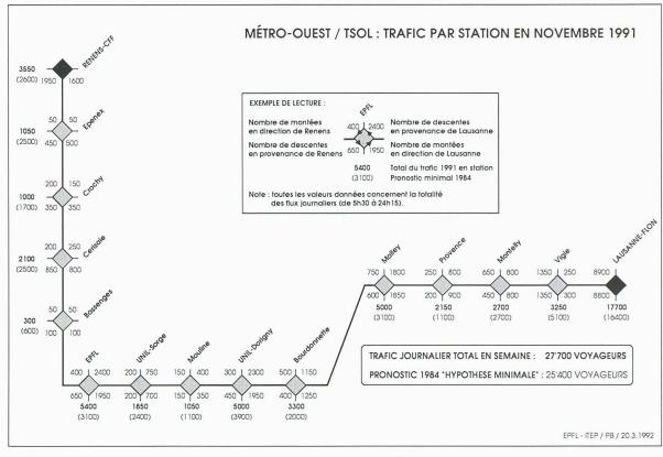
Fig. 4. — Trafic TSOL par station en novembre 1991 et comparaison avec le pronostic 1984
