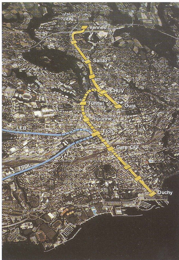
Fig. 15. – Etagée face au lac sur une hauteur de plus de 300 m, Lausanne a besoin d'un transport «de montagne» pour relier les différents paliers qui la composent. Le développement actuel des transports urbains à câble permet de proposer une solution automatique à grande capacité par un transport continu, donc sans stress, respectueux de l'environnement, fiable et bien moins coûteux qu'un métro.
