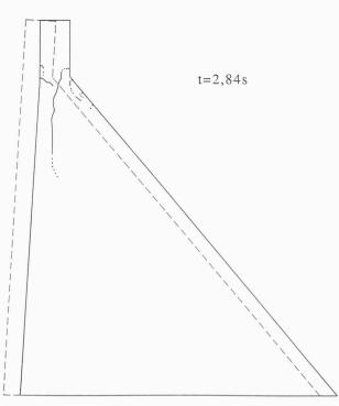
Fig. 2. – Exemple de calcul utilisant la mécanique de la rupture: fissuration d'un barrage lors d'un séisme [5]
