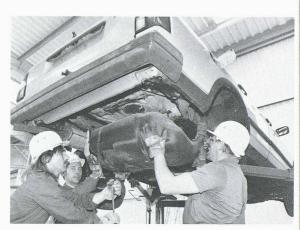
Projet pilote de récupération et de recyclage de vieilles carcasses d'automobiles en Allemagne du nord: dans une entreprise de Leer, en Frise orientale, des ouvriers sont en train de démonter le réservoir en plastique d'un véhicule devenu irréparable.
