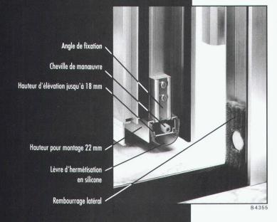
En nouveauté, le dispositif d'hermétisation Planet est aussi disponible pour les portes en aluminium. Absolument étanche. Ce dispositif bouche la fente sous la porte et rend les seuils superflus. Amoindrir les bruits — éviter le gaspillage de chauffage — faciliter le passage des patients en fauteuil roulant — supprimer les courants d'air — éviter la propagation de feu et de fumée en cas d'incendie! Le dispositif sous-porte est prêt à monter sans difficulté. Demandez notre documentation.
