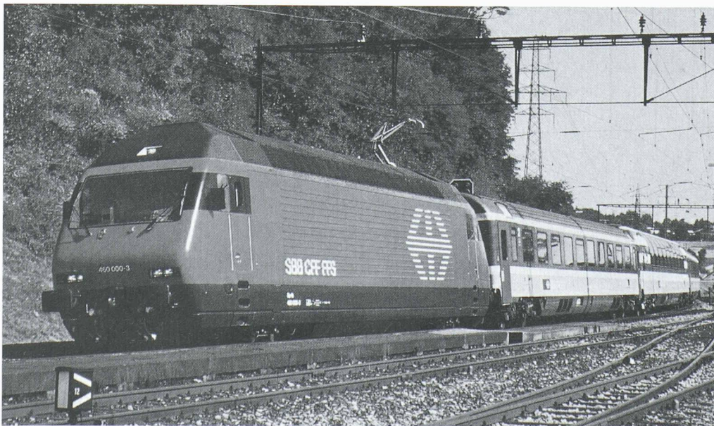
Les CFF à l'aube du XXI e siècle: locomotive dite 2000 (vitesse maximale: 230 km/h) remorquant une voiture pour services internationaux et une voiture panoramique (toutes deux homologuées pour 200 km/h) (photo SWISSRAIL)
