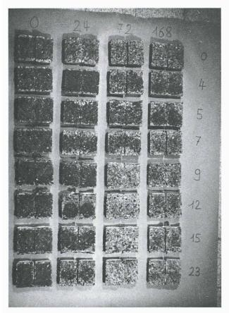
Fig. 6. - Profondeur de carbonatation déterminée à l'aide d'un indicateur d'alcalinité après 0, 24, 72 et 168 heures d'essais de carbonatation accélérée sur des carottes de béton enduites d'une protection en parties supérieure et inférieure (l'indicateur vire au rouge quand le pH du béton est supérieur à 9 et est donc alcalin)
