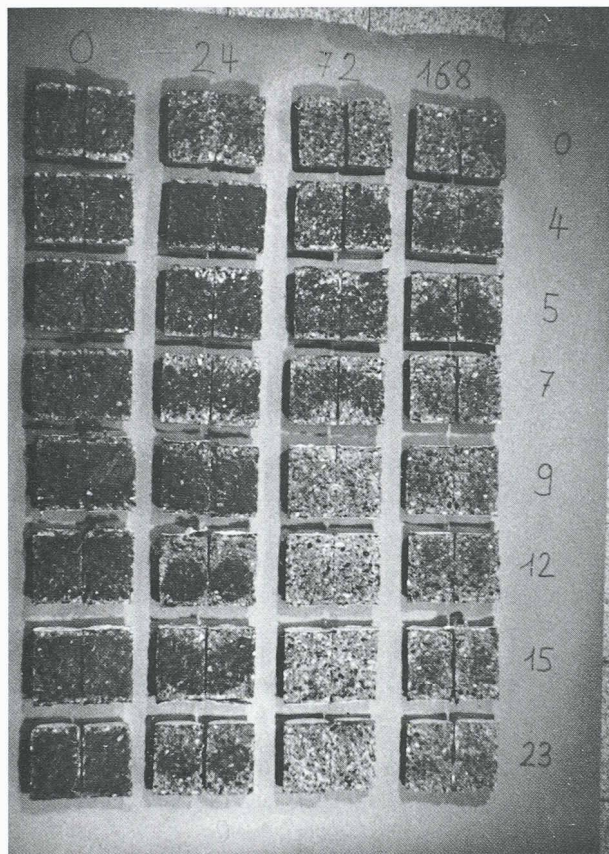
Fig. 6. — Profondeur de carbonatation déterminée à l'aide d'un indicateur d'alcalinité après 0, 24, 72 et 168 heures d'essais de carbonatation accélérée sur des carottes de béton enduites d'une protection en parties supérieure et inférieure (l'indicateur vire au rouge quand le pH du béton est supérieur à 9 et est donc alcalin)
