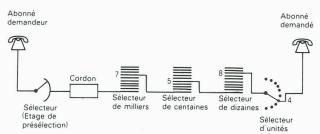
Fig. 4. - Principe d'un commutateur pas à pas (La Commutation électronique, par GRINSEC, Paris, Eyrolles, 1980)
