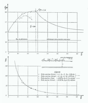
Fig. 5. – Hauteur maximale  $h^*_{max}/h'$  et longueur maximale e/h' de l'onde de translation positive par rapport à la hauteur relative de l'onde h'/H (Favre, 1935a)
