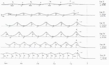
Fig. 48 (3mº série. Exp. Nºº 21, 22, 23, 24, 26 et 29). — Ondes positives d'amont: i = 0, U<sub>0</sub> = 0, H<sub>0</sub> = 1,075 dm., hauteur moyenne h' de la tête variable. Profils en long des ondulations stables constituant la tête de l'intumescence. s<sub>A1</sub> = distance de la crête de la première ondulation à l'extrémité du canal où l'on produisait les intumescences. (le rapport des échelles verticale et horizontale du dessin est égal à 5).
