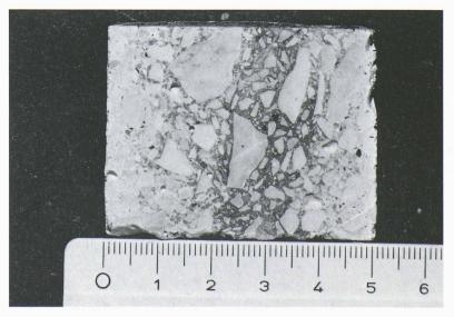
Fig. 3. – Résultat de la carbonatation sur un échantillon de béton préfabriqué. Profondeur de carbonatation de 6,5 mm maximum après vingt-cinq jours d'essai accéléré
