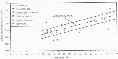
Fig. 3. - Section équivalente - portée, élancement.
