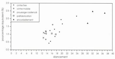
Fig. 4. - Taux équivalent d'armature de précontrainte - portée, élancement.
