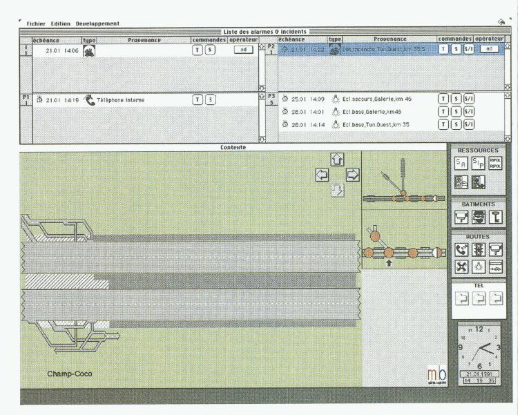
Fig. 4. - Prototype de l'interface homme-machine sur une station de travail d'opérateur. zone supérieure contient les alarmes, regroupées selon leurs priorités. La zone infécontient contexte de l'alarme, en général sa situation sur le terrain. La zone de droite contient des «palettes d'outils» permettant à l'opérateur d'accéder aux diverses informations.
