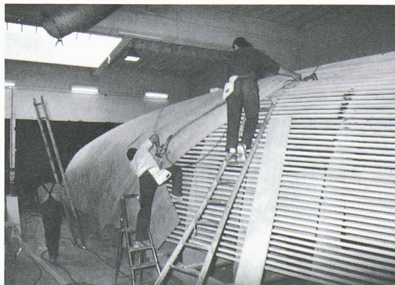
Merit: la naissance d'un coursier des mers. Le mannequin matérialise les formes créées par l'architecte Bruce Farr. Sept couches de fibres de carbone imprégnées de résine époxy Kevlar sont collées sur le mannequin.
