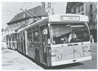
Les trolleybus TL captent leur courant avec des perches en matériaux composites.
