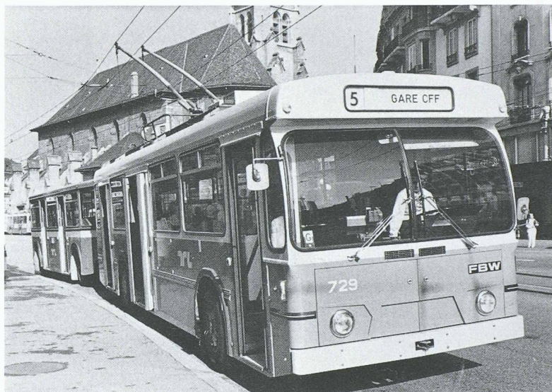
Les trolleybus TL captent leur courant avec des perches en matériaux composites.
