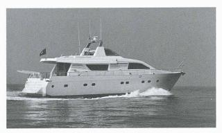
Alalunga Composit 22: 22 m de long, 5,76 m de large, 39 t à pleine charge,  $2 \times 1100$  CV, 38 nœuds (70 km/h) de vitesse maximale.
